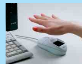
非接触型 手のひら静脈認証ログインシステム Contactless palm vein authentication login system
